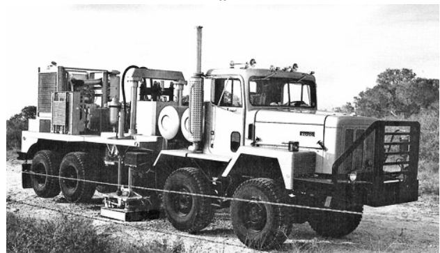
Рисунок 4 – Испытания силового трансформатора на виброустойчивость: а – схема испытаний; б – внешний вид мощного мобильного вибратора LRS – 321 фирмы Western Manufacturing (США)
