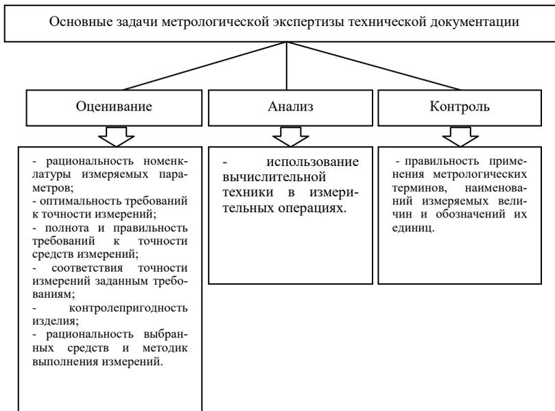
Рис. 1 – Основные задачи метрологической экспертизы технической документации
