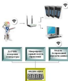
Рис. 1 – Функциональная схема системы дистанционного мониторинга температуры
