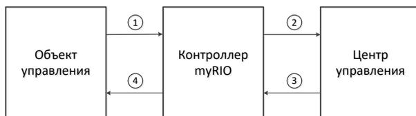
Рис.1 – Функциональная схема системы управления удаленным объектом
