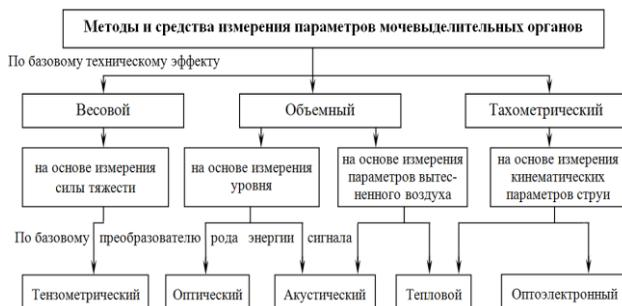
Рис. 1 – Классификация параметров методов и средств измерения параметров мочевогоделительных органов
