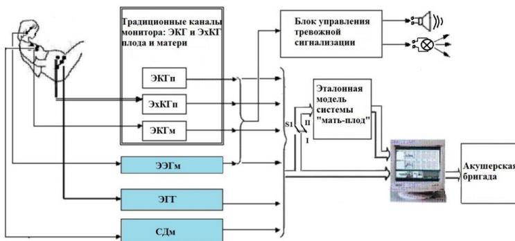
Рис.1 – Концепция структурного построения автоматизированной системы акушерского мониторинга с расширенными функциональными возможностями
