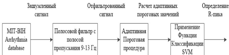
Рис. 1 – Алгоритм детектирования QRS-комплекса
