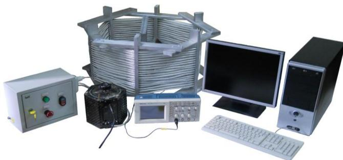
Рис. 3 – Действующий макет системы неинвазивного магнитоиндукционного исследования биологических объектов
