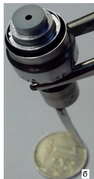
Рис. 1. КПУ-1: а – схема КПУ-1: 1 – эмиттер, 2 – подогреватель, 3 – блок экранов, 4 – стержневые тепловые развязки, б – внешний вид КПУ-1
