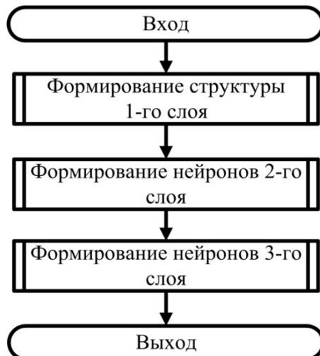
Рис. 4. Алгоритм синтеза модуля нейро-нечеткой сети
