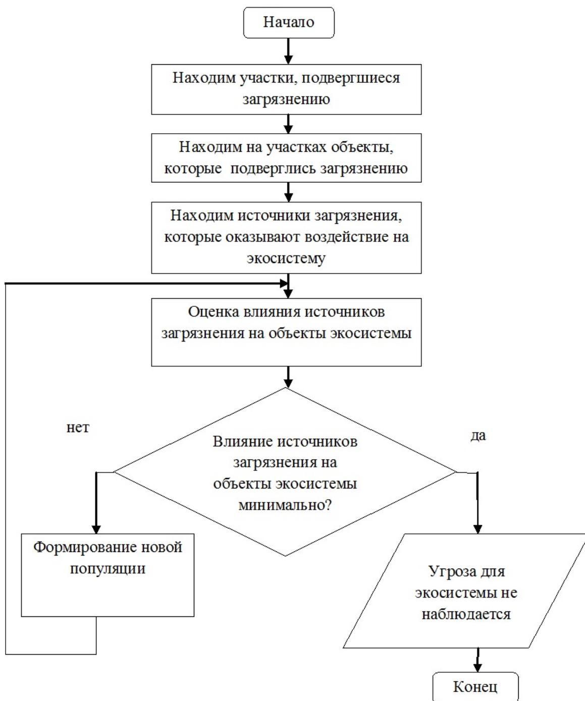
Рис. 2. Функциональная схема генетического алгоритма экологического мониторинга
