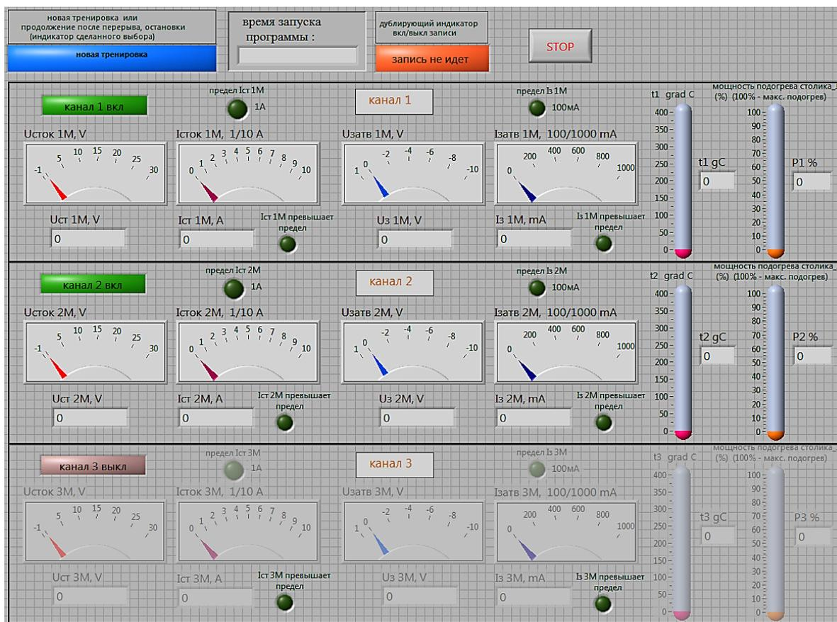
Рис. 2. Лицевая панель виртуального прибора для блока управления ТЕ20-3К
