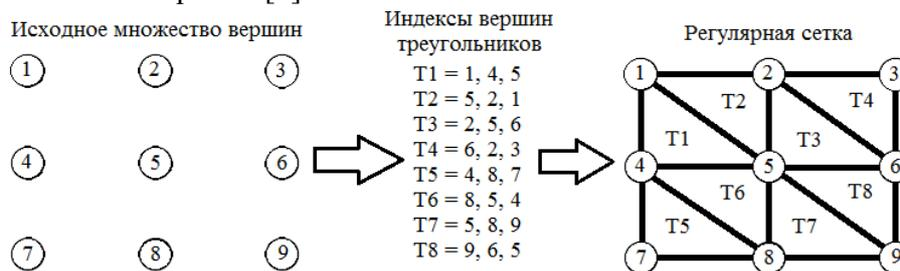
Рис. 3. Построение регулярной сетки на множестве вершин (триангуляция)
