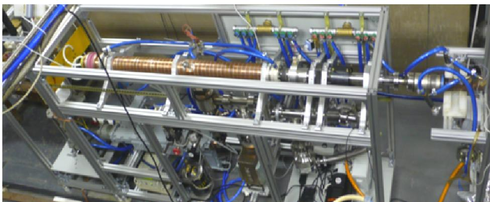
Рис. 9. Ускорительная секция излучателя электронов
