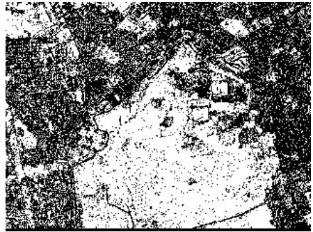
Рисунок 8 – Результат текстурной обработки с применением признака «Корреляционная размерность» после классификации
