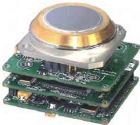
Рис.7. Фотоприемник с платами предварительной цифровой обработки
