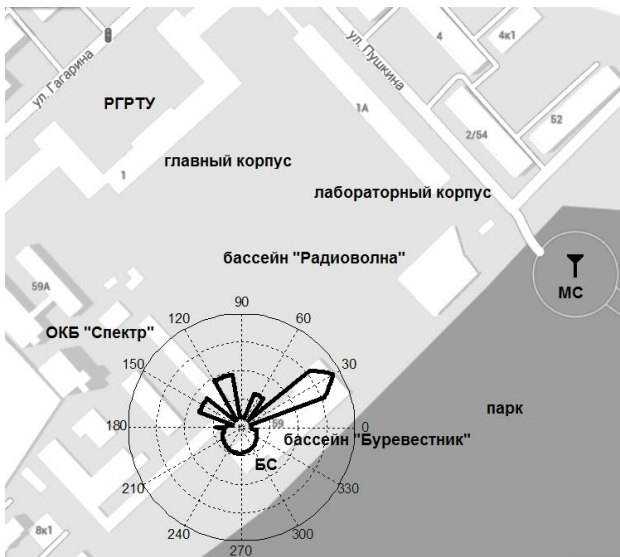
Рисунок 1 – Азимутальный спектр мощности базовой станции
