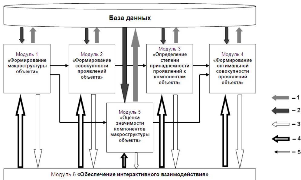
Рис. 3. Обобщенная архитектура программного комплекса: 1 – информационные потоки, обеспечивающие пополнение и корректировку базы данных; 2 – информационные потоки, обеспечивающие реализацию процедур модуля; 3 – информационные потоки, обеспечивающие интерактивность программы; 4 – информационные потоки, реализующие интерактивные взаимодействия экспертов с программой; 5 – внутрисистемные информационные потоки.
