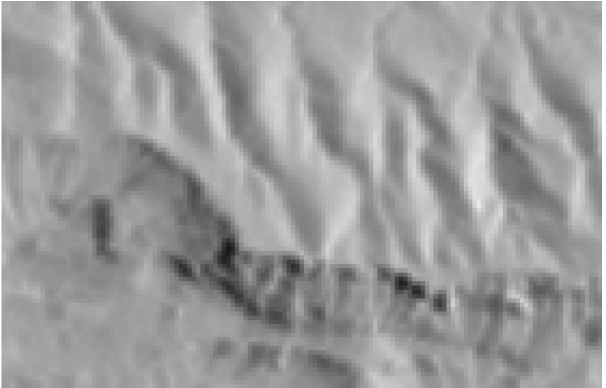
Рисунок 3.5 – Карта значений степени растяжения пикселей радиолокационного изображения при деортотрансформировании
