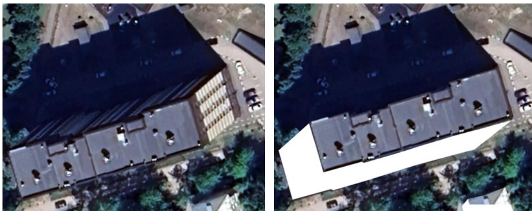
Рисунок 1.1 – Геокодированное оптическое изображение высотного здания (слева) и пропуски данных на результате ортотрансформирования (справа)
