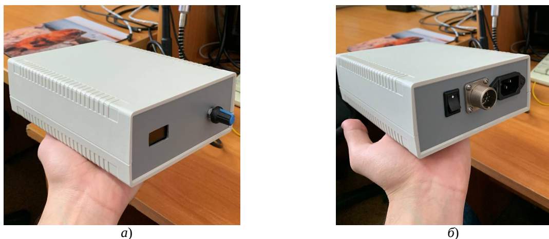
Рис. 2. Передняя (а) и задняя панели корпуса (б) установки для исследования температурной зависимости диэлектрической проницаемости сегнетоэлектриков
