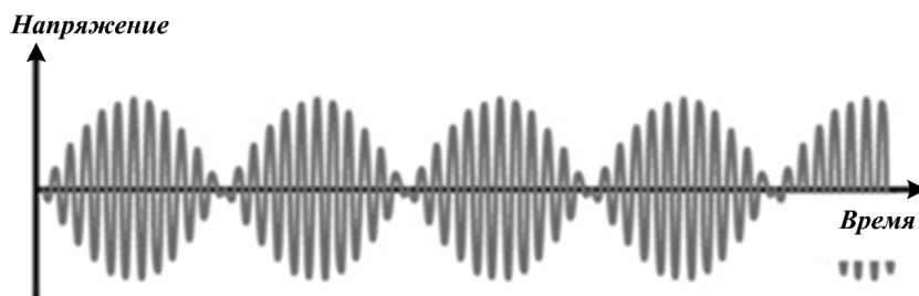
Рис. 2. Входной испытательный сигнала для определения IMD
