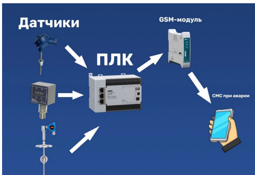
Рис. 1. Структура системы автоматического SMS-оповещения
