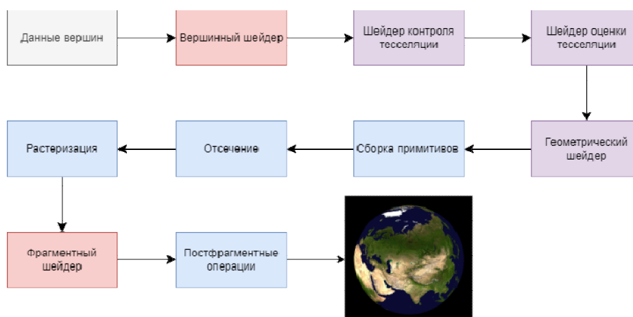
Рис. 1. Конвейерная архитектура OpenGL
