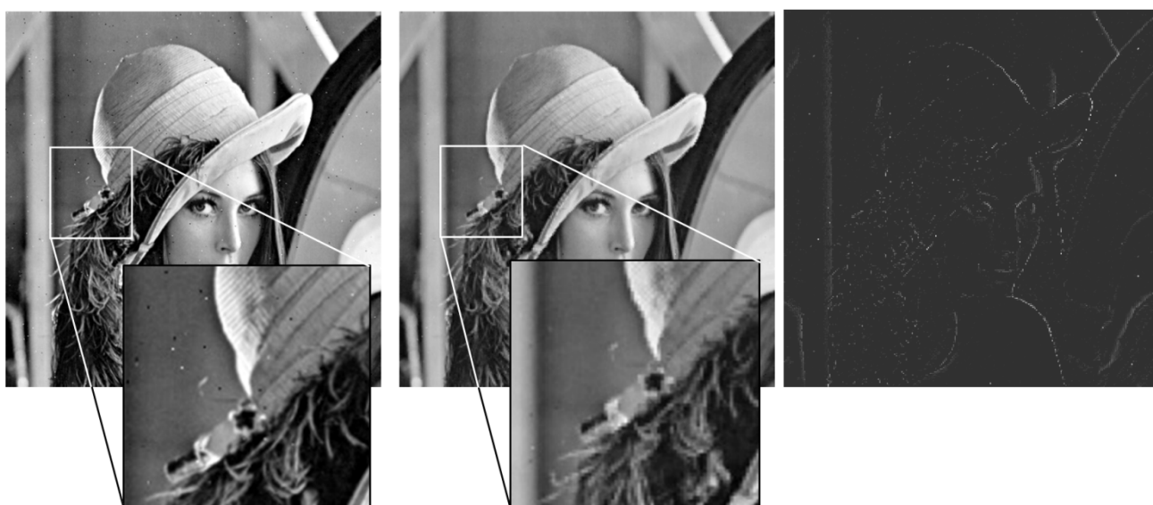
Рис. 3. Слева - изображение с шумом, по центру – результат фильтрации, справа - разностный снимок
