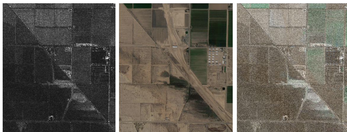
Рис. 3. Радиолокационное изображение (слева), оптическое изображение (по центру) и результат раскраски (справа)
