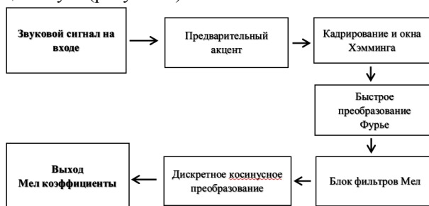
Рисунок 1 – Структурная схема для получения коэффициентов MFCC
