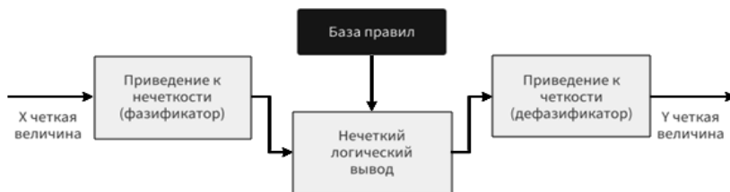
Рисунок 3 - Типовая структура системы нечёткого вывода
