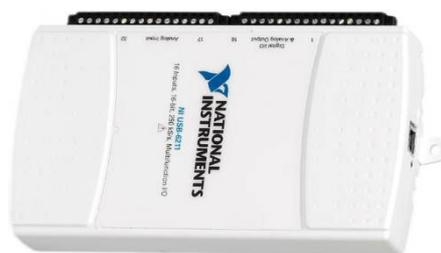
Рис. 2. Многофункциональное устройство ввода-вывода NI USB 6211
