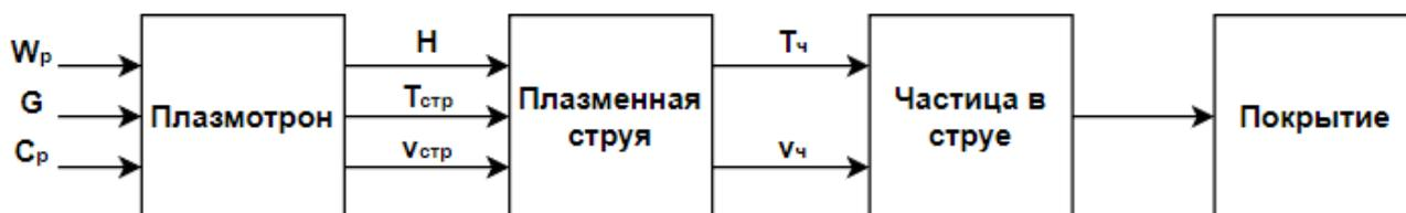
Рис. 4. Этапы процесса плазменного напыления
