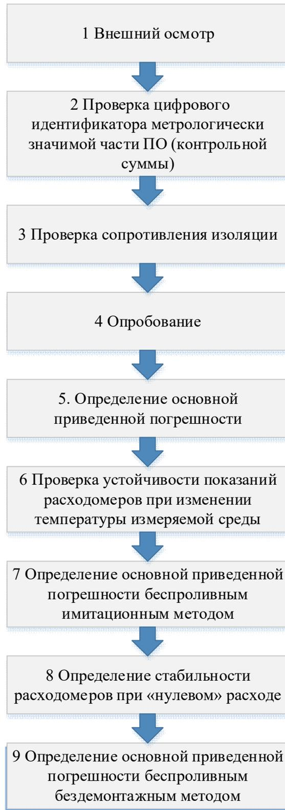
Рис. 1. Процесс поверки расходомера
