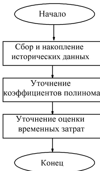
Рис. 1. Блок-схема алгоритма уточнения оценки
