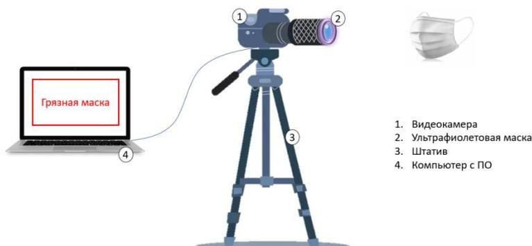
Рис. 1. Схема устройства, распознающего степень загрязненности маски
