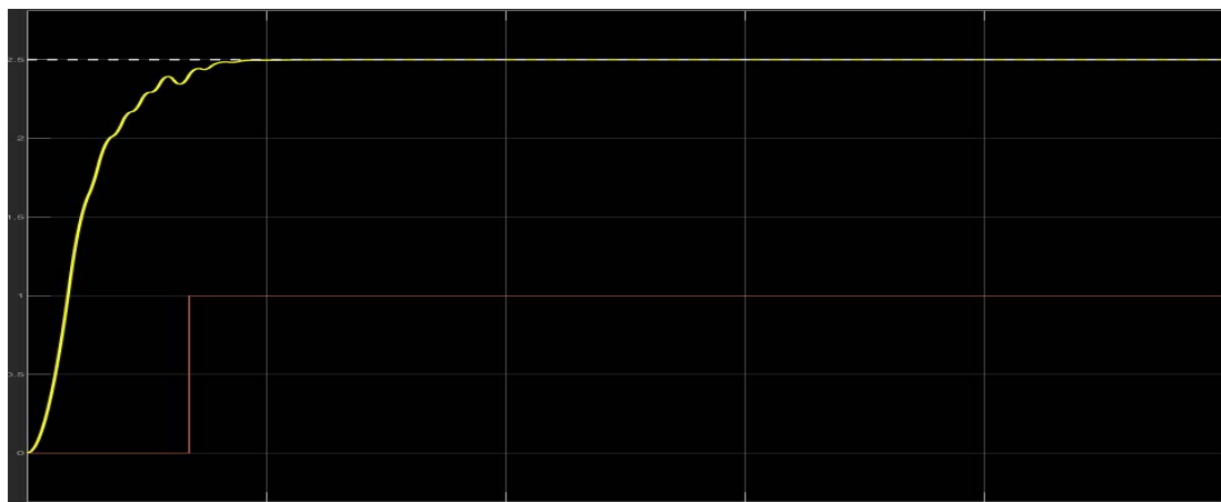
Рис. 7. Диаграмма выходной величины с ШИМ управляющего воздействия
