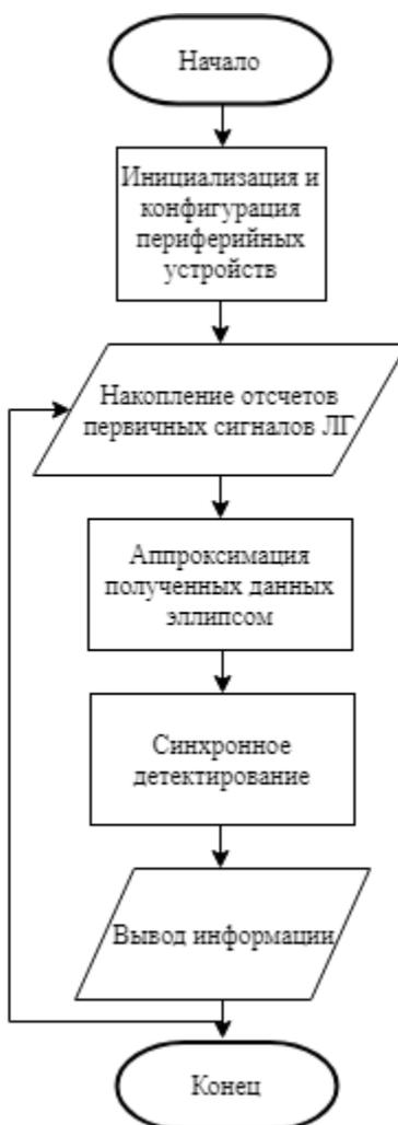
Рис. 2. Функциональная блок-схема работы системы цифровой обработки данных ЛП
