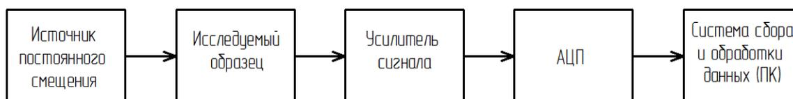
Рис. 1. Структурная схема установки для измерения спектров электрического шума аналого-цифровым методом
