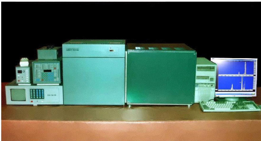
Рисунок 5 - Внешний вид хромато-масс-спектрометра, построенного на основе трёхмерной ловушки с импульсной формой ВЧ напряжения
