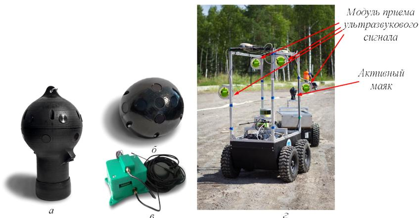
**Рисунок 4. ИИК определения взаимного положения ведущего и ведомого ТС: а – активный маяк, б – модуль приема ультразвукового сигнала, в – модуль синхронизации и сбора данных, г – пример положения ИИК на двух мобильных роботах типа «Вомбат»**
