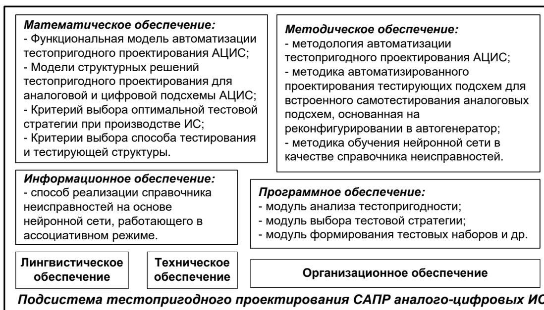
**Рисунок 1** – Составные части подсистемы тестопригодного проектирования САПР аналого-цифровых ИС
