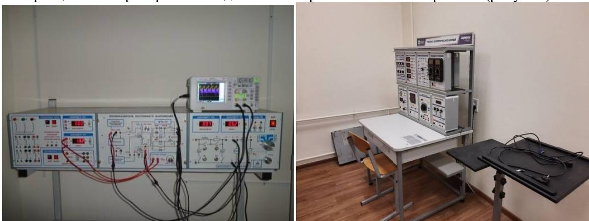
Лабораторные стенды по электропитанию устройств и систем (слева - осциллограммы напряжения и тока на осциллографе DS01052B 50 MHz)), электротехнике (справа)
