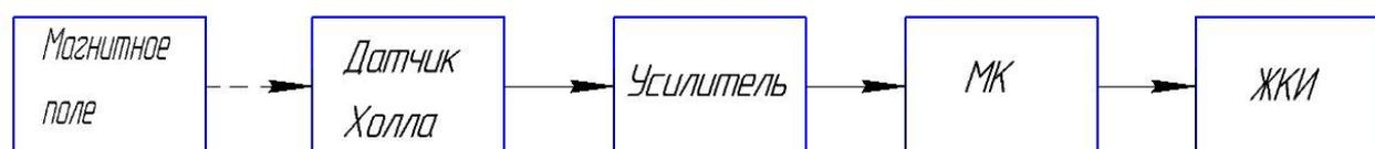
Рис. 1. Функциональная схема канала контроля параметров магнитного поля
