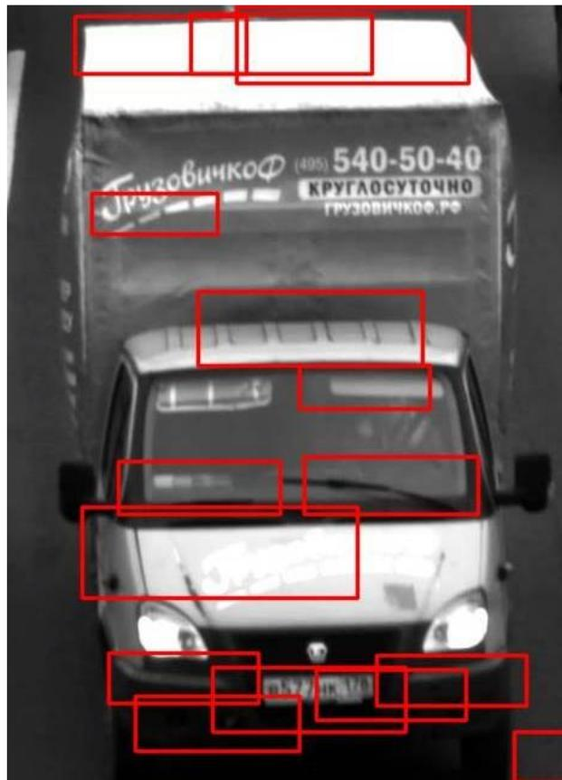
Рис. 2. Результат ложного распознавание изображения каскадом Хаара
