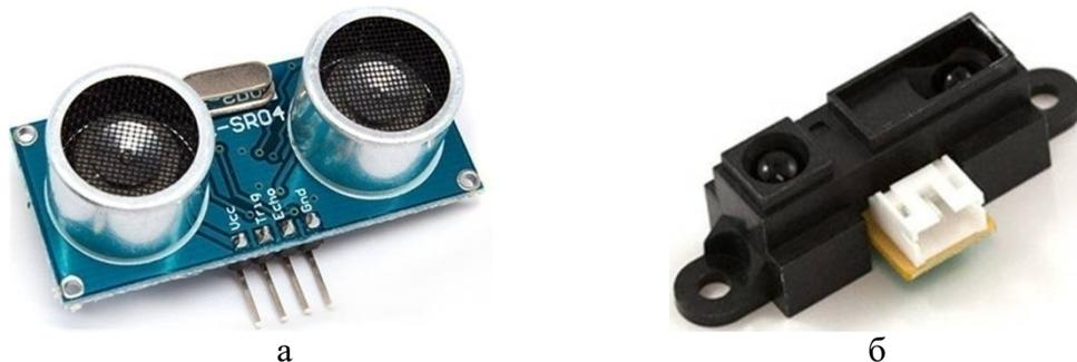
Рис. 1. Ультразвуковой (а) и лазерный (б) дальномеры
