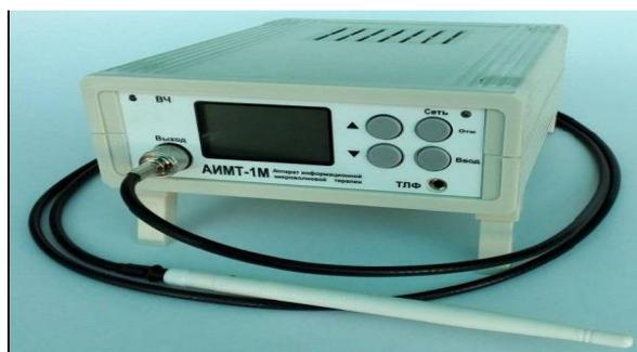
Рис.2 – Устройство моделирования микроволнового излучения Солнца (АИМТ-1) в диапазоне частот (4,0-4,3)ГГц
