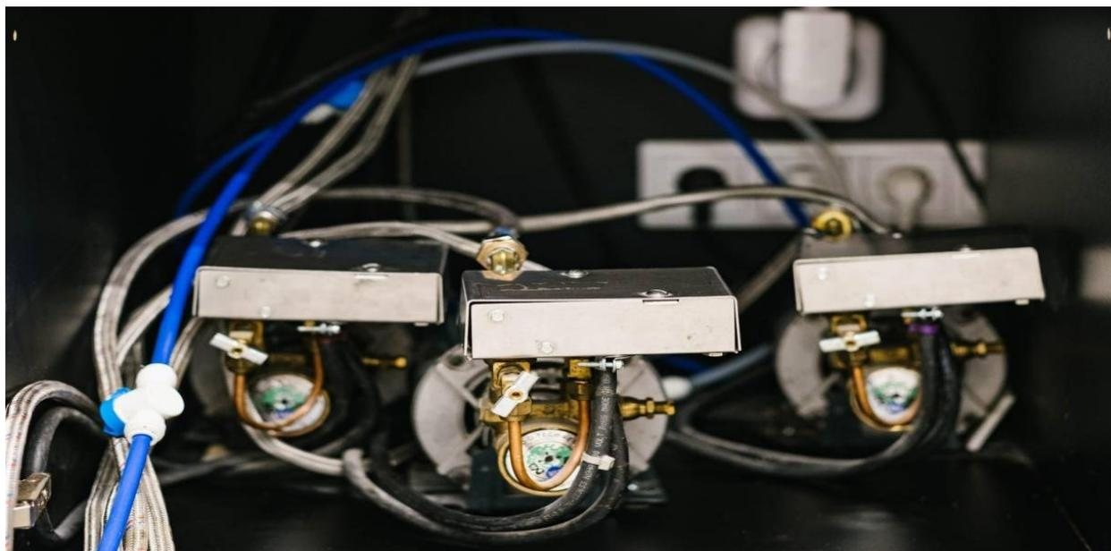
Рис. 1. Три выносные помпы, установленные в шкафчике под барной стойкой от кофемашины Synesso Hydra
