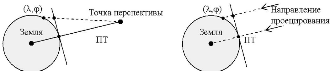
Рис. 3. Принципы представления изображений в проекции вертикальной ближней перспективы (слева) и ортографической проекции (справа)
