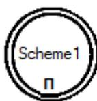
Рис. 4. Пример изображения ссылки на схему перехода в графическом языке IDEF5
