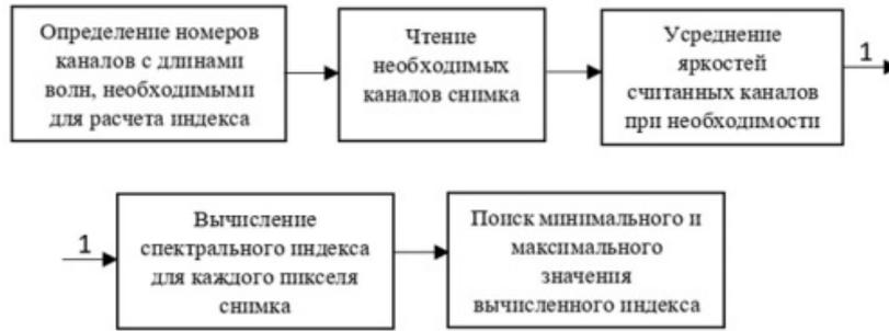
Рис. 4. Схема построения индексного изображения
