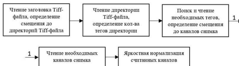
Рис. 3. Схема распаковки и визуализации гиперспектрального снимка
