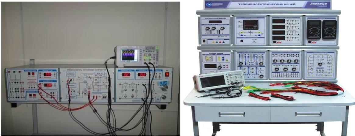
Рис. 3. Учебно-исследовательские стенды для исследования электромагнитных процессов в электропреобразователях БТС, электродной технике и влияния ЭМВ на РО (слева - осциллограммы напряжения и тока на осциллографе DSO1052B 50MHz)
