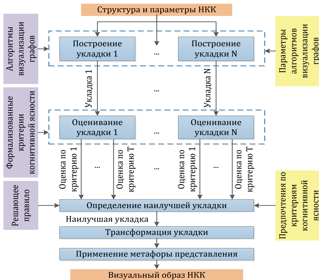
Рисунок 3 – Алгоритм метода построения оптимальной метафоры визуализации НКК
