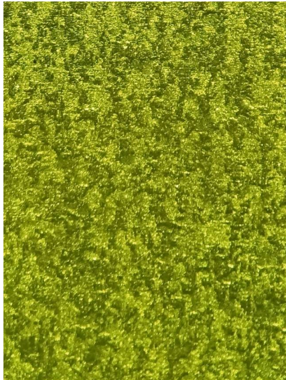
Рис. 2. Микрофотография поверхности никелевого покрытия, полученного в условиях стационарного электролиза
