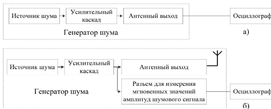
Рис. 3. Схема измерения маскирующего шумового сигнала ГШ с применением цифрового запоминающего осциллографа: а) подключенного к антенному выходу ГШ; б) подключенного к специальному разъему ГШ.
