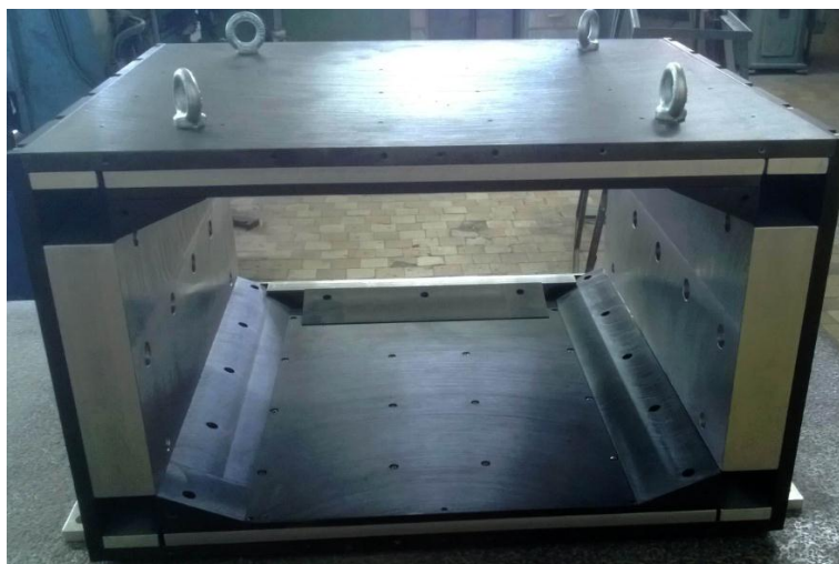
Рис. 8 Общий вид изготовленной магнитной системы нейтронного анализатора рефлектометра РЕМУР
