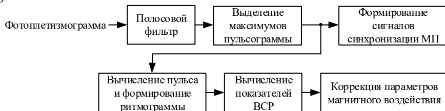
Рис. 1 – Структура алгоритма цифровой обработки сигнала ФПГ
