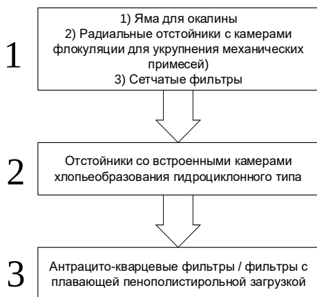
Рис. 1 – Трехступенчатая очистка воды
