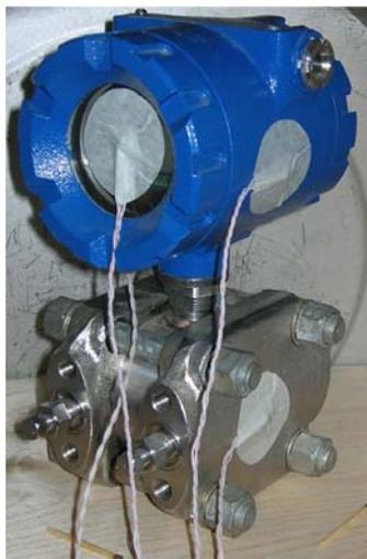
Рисунок 6 – КХТ с загруженной в нее партией ИП и точки измерения температуры на ИП “Сапфир-22МР”.
